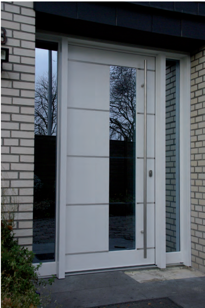
H482: Weiß, Lichtausschnitt mit flächenbündiger, verdeckter Verleistung, VA-Stahl-Lisenen 15mm flächenbündig eingelegt
