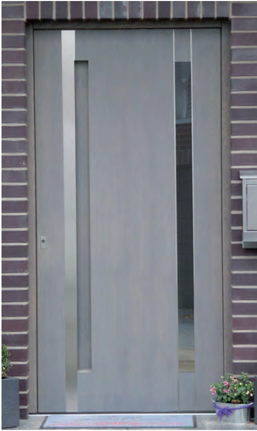
H211 (LINKS) & H212 (RECHTS): Oberfläche Eiche grau lasiert, Lichtausschnitte mit Stufenfalz, VA-Lisenen 15mm flächenbündig eingelegt, VA-Stoßgriff mit Griffmulde in Teillänge (LINKS)/durchgehender Griffmulde (RECHTS)
